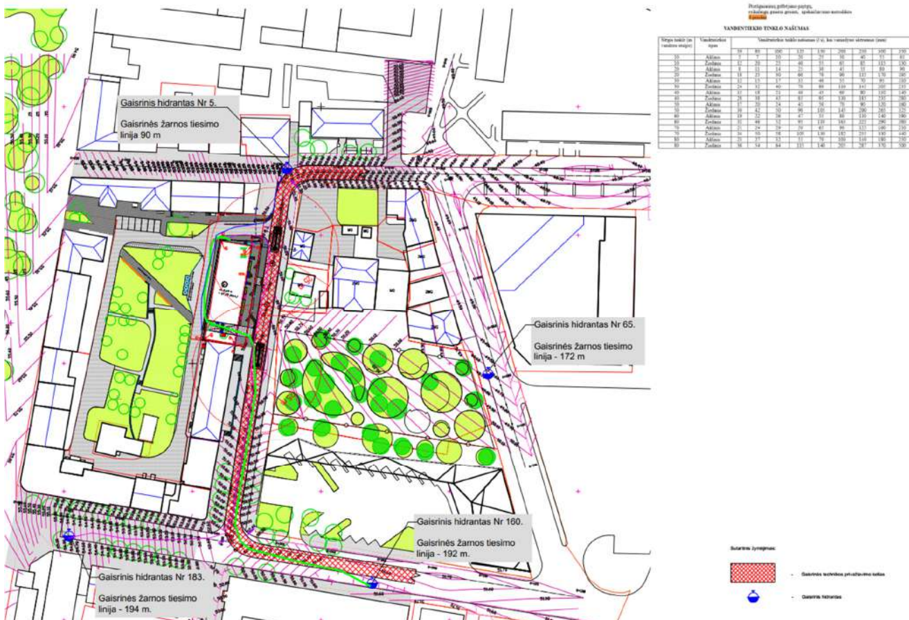
Priešgaisrinių hidrantų schema
